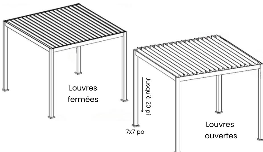
Un espace minimum de 12 pouces est nécessaire entre le bas de la poutre et le haut des louvres pour l'installation.
